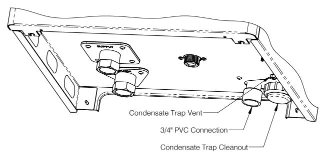
Figure 13-1: Condensate Trap
